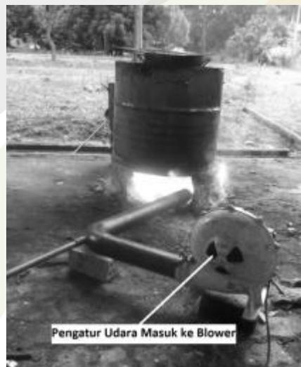
Gambar 3. Sistem Kowi Terpasang dengan kelengkapannya [6]
