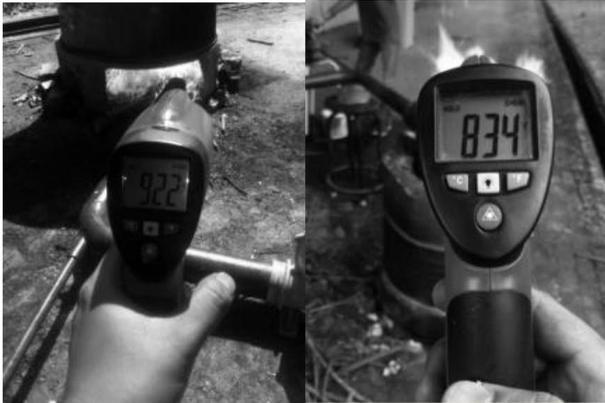
Gambar 4. Hasil Uji Ukur dengan Thermogun Infra Red [6]
