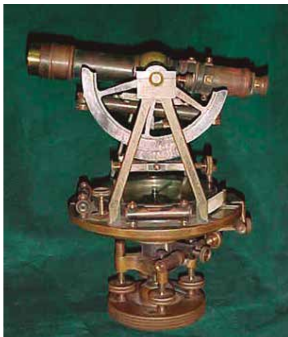
Figura 3: Teodolito-Trânsito de fabricação inglesa | Foto: Iran Corrêa
