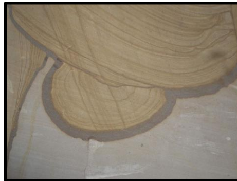
Figure II-2 : Anneaux de "Liesegang" centimétriques sur un bloc de grès à Meules en carrière (carrière d'Adamswiller, Alsace).
