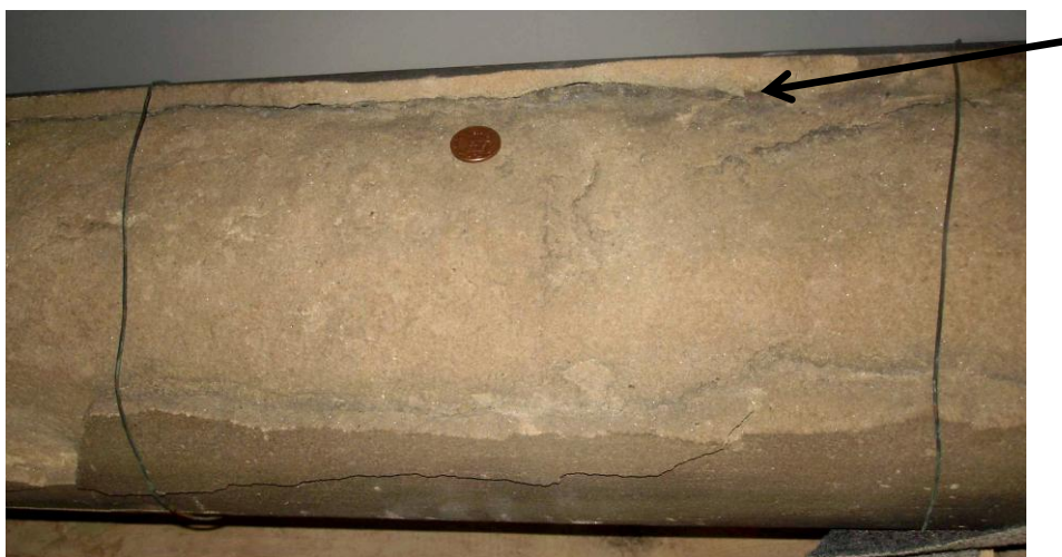
Figure A6-5 : Aspect de la desquamation observée sur une colonnnette déposée du XVII e siècle. La zone de prélèvement est indiquée par la flèche.
