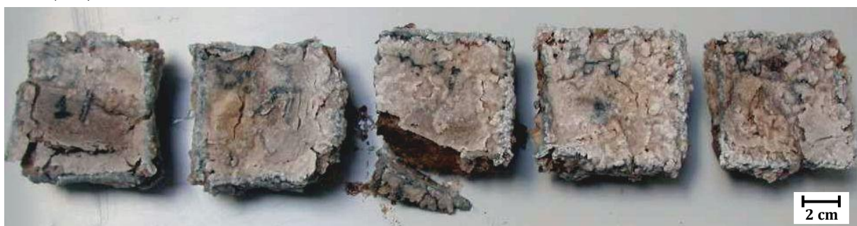
Figure IV-2 : Etat final des éprouvettes de grès à la fin du test de cristallisation-dissolution des sels au sulfate de sodium. Le nombre entre parenthèses correspond au nombre de cycles réalisés.
