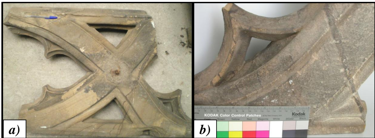
Figure II-4 : Aspect macroscopique de l'élément ancien et durable (SO) mis en œuvre sur la flèche depuis 1420. a) élément déposé ; b) détail de la bande centimétrique ou "anneaux de Liesegang".
