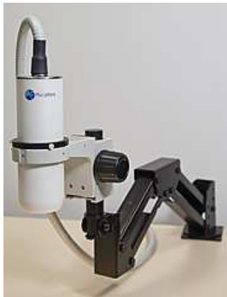
Figure VI-9 : Photographie représentant la sonde Fluobeam™, commercialisée par Fluoptics®
