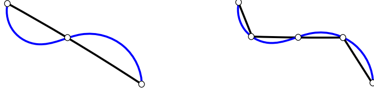
Figure III.1.2 – Frontière courbe (en bleu) et maillages P1 associés (en noir) : maillage trop large (à gauche) et maillage suffisamment fin (à droite)
