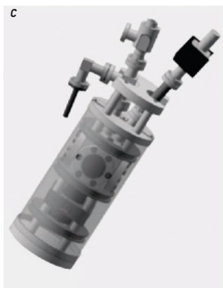
2. L'EXPÉRIENCE EMBARQUÉE dans l'Airbus ZERO-G pour tester le principe d'équivalence occupe une bonne partie de l'avion (a). Les physiciens travaillent à la rendre plus compacte (b), leur objectif étant de la contenir dans un boîtier transportable de la taille d'une malle (c), afin de l'envoyer dans l'espace à bord d'un satellite.
