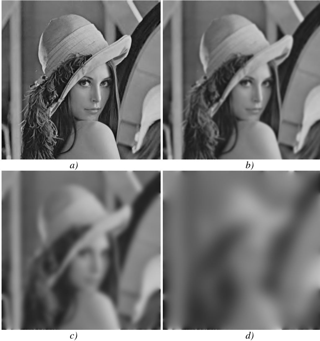
Figure 2.1 : Filtrage gaussien à différentes échelles a) Image originale ( t=0 ) et les résultats obtenus pour b) \sigma=2.45 ( t=3 ) c) \sigma=7.745 ( t=30 ) d) \sigma=24.5 ( t=300 )
