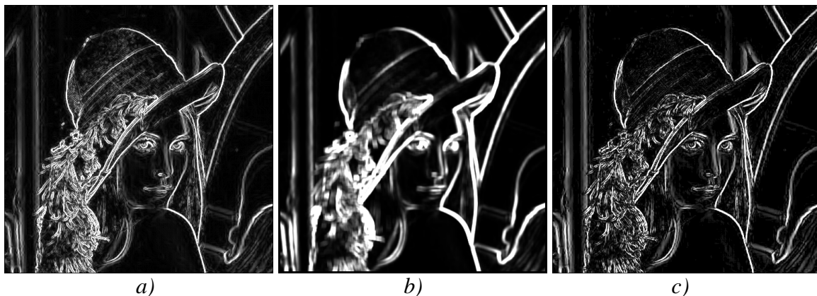
Figure 1.13 : Exemple de mesures de pertinences sur l'image de Lena (Fig. 1. 9a); a) la norme du gradient ; b) la variance calculée dans une fenêtre 4*4 ; c) la pertinence de Petrovic et Xydeas (éq. 1.63)
