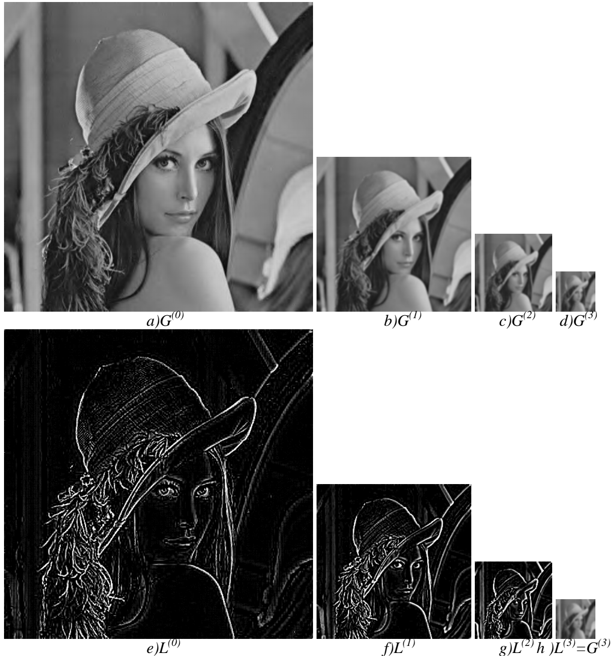
Figure 1.8 : Décomposition sur 3 niveaux : Pyramide a-d) Gaussienne et g-h) Laplacienne
