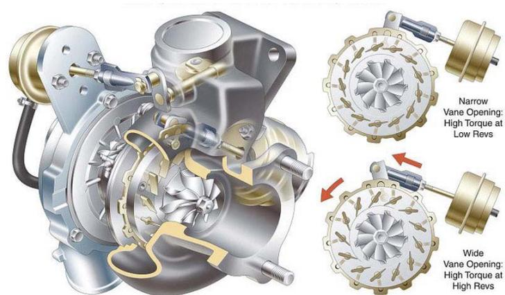
Figure 4. 13 : Turbocompresseurs à orientation des aubes variables
