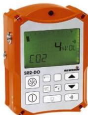
**Figure 75: Appareil Sewerin SR2DO pour l'analyse des biogaz sur le terrain.**
