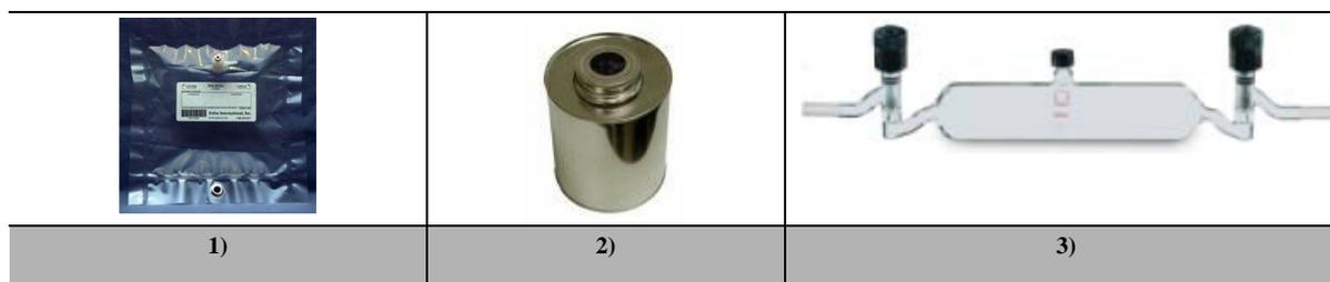
**Figure 28:** Photographies de contenant à gaz 1) Sac Tedlar®, 2) Canister en métal, 3) Ampoule en verre.
