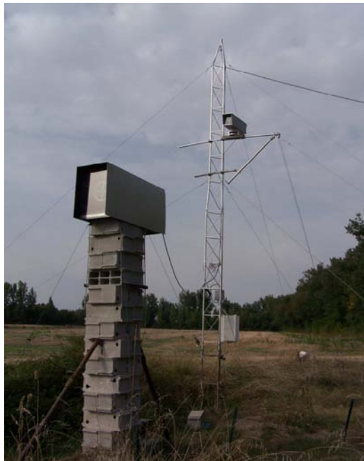
Photo n°1 : Prototype de scintillomètre installé sur une tour de parpaings (hauteur 3m) et LAS (modèle Wageningen) sur un mât (hauteur 6m), sur le site de Lamasquère (31)
