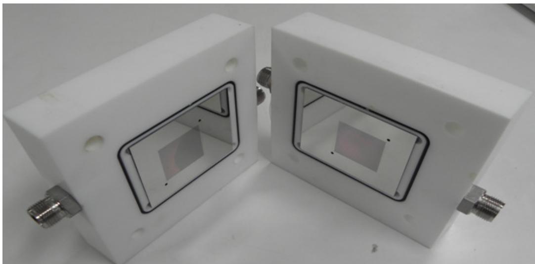
Fig. 3.29 : Photo du cadre en téflon et des électrodes sur support silicium.
