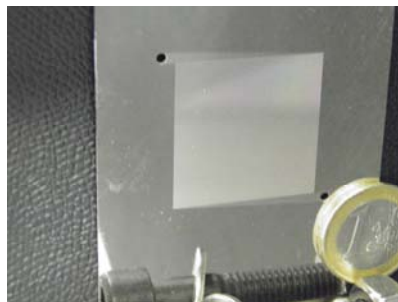
Fig. 3.26 : Electrode sur support silicium réalisée par photolithographie après optimisation des distributions des temps de séjour (angle \theta = 1,82^\circ ).
