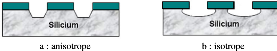
Fig. 1.3 : Attaque chimique anisotrope (a) et isotrope (b).
