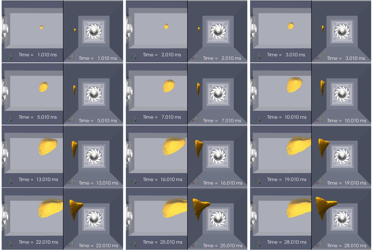
FIGURE 9.28: Simulation d'une séquence d'allumage pour un dépôt d'énergie au niveau de la bougie  $116mm$ , conditions de référence, iso-contour de température  $T_g = 1300K$  (vues longitudinale/latérale simultanées).
