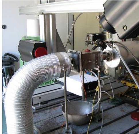
FIGURE 6.6: Montage PDI sur MERCATO, sans chambre de combustion.
