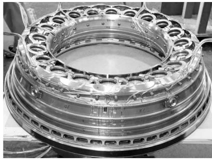
FIGURE 2.3: Photographie d'une chambre de combustion annulaire, d'après [Mongia \(2004\)](#).
