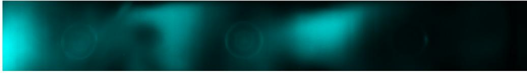
FIGURE 11.11: Luminance moyennée de la flamme, carburation des injecteurs principaux seuls (vue du fond de chambre).
