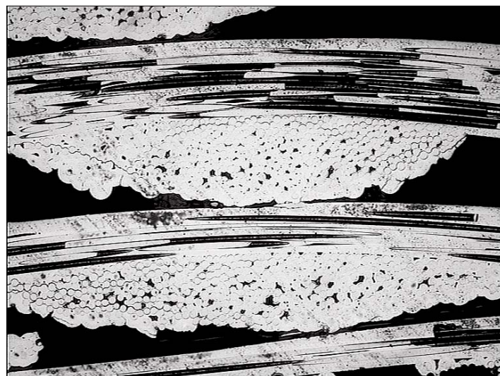
FIGURE 4.23 – Micrographie du composite étudié : détails de la mésostructure à l'état initial
