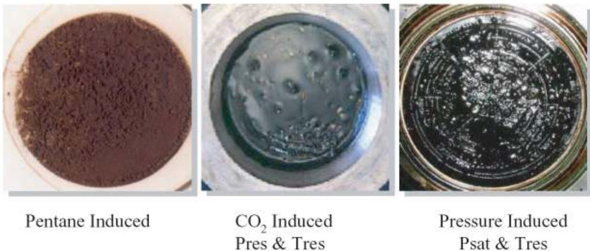
Figure I-17 Flocculation des Asphaltènes suivant différentes conditions
