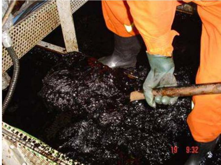
Figure I-8 Dépôt d'asphaltènes induit par un changement de composition
