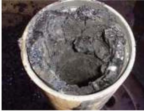
Figure I-18 Canalisation bouchée par un dépôt d'asphaltènes
