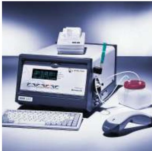
Figure III-12 Viscosimètre SVM 3000 Stabinger (Anton Paar)
