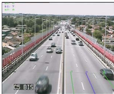
FIGURE 6.16: Illustration du placement des scanlines pour le comptage de véhicules sur la séquence C5. Il s'agit de segments de petites tailles placés dans les zones d'entrée de la scène, au centre des voies de circulation.
