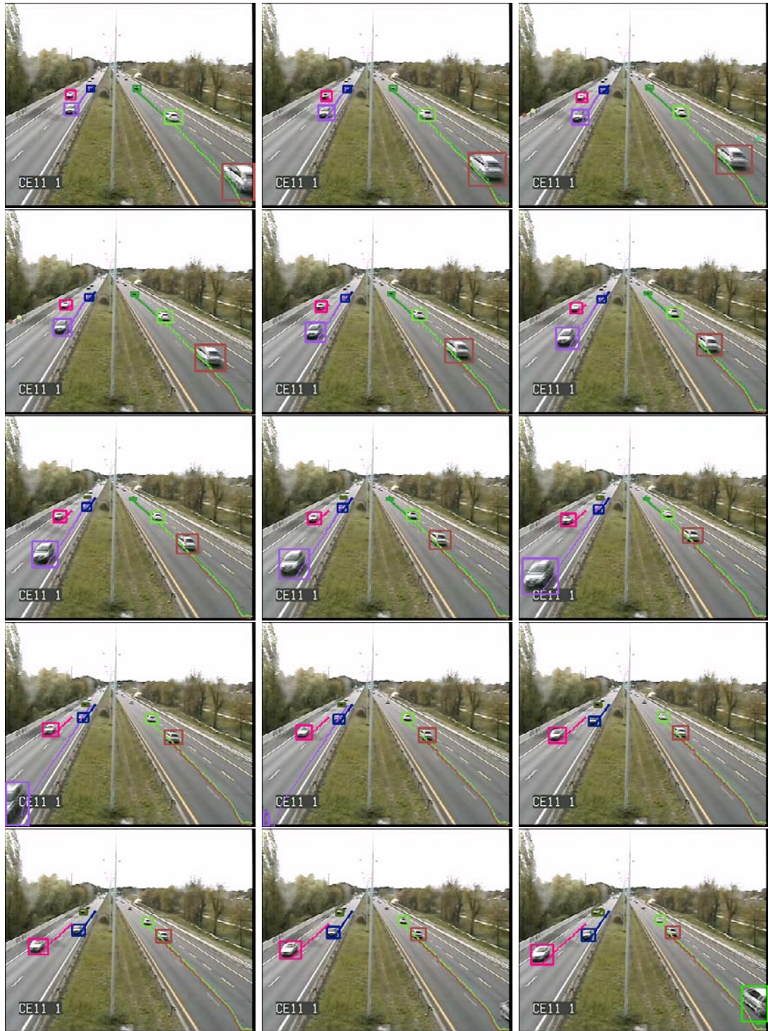
FIGURE 5.21: Exemple de trajectoires issues du processus de suivi d'objets pour la séquence C11.
