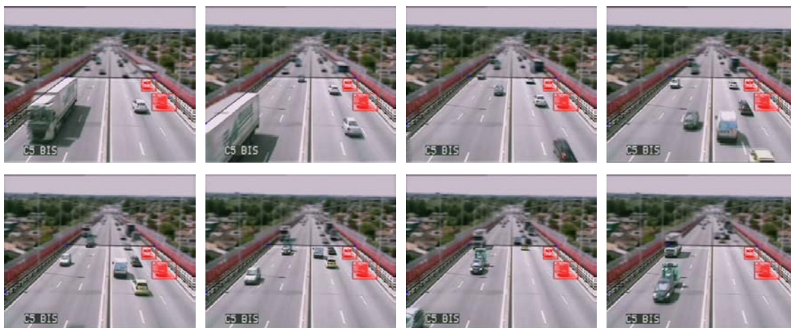
FIGURE 6.5: Illustration de la détection d'arrêt de véhicules sur la séquence de test C5. La séquence a été manuellement modifiée pour simuler l'arrêt de véhicules sur la chaussée. La détection d'arrêt est affichée à l'aide de boîtes englobantes rouges sur les véhicules détectés.
