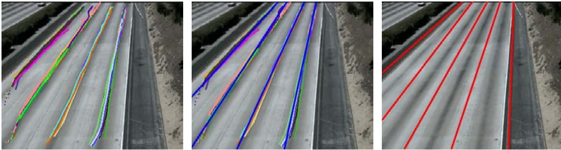
FIGURE 3.10: Utilisation des trajectoires pour l'extraction des bordures des voies. A gauche - Trajectoires (couleurs aléatoires), Au centre - Trajectoires et approximation par une droite (en bleu), A droite - Estimation des bordures des voies (en rouge).
