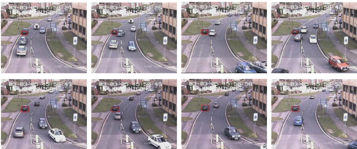
FIGURE 6.7: Illustration de la détection d'arrêt de véhicules sur la séquence de test publique I-LIDS-Medium. La détection d'arrêt est affichée à l'aide de boîtes englobantes rouges sur les véhicules détectés.
