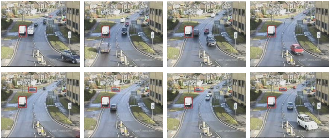
FIGURE 6.6: Illustration de la détection d'arrêt de véhicules sur la séquence de test publique I-LIDS-Easy. La détection d'arrêt est affichée à l'aide de boîtes englobantes rouges sur les véhicules détectés.
