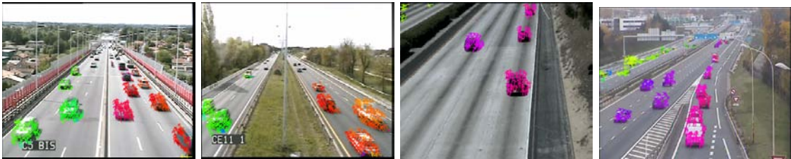
FIGURE 4.5: Exemple d'estimation du déplacement des vecteurs mouvements pour quelques séquences.
