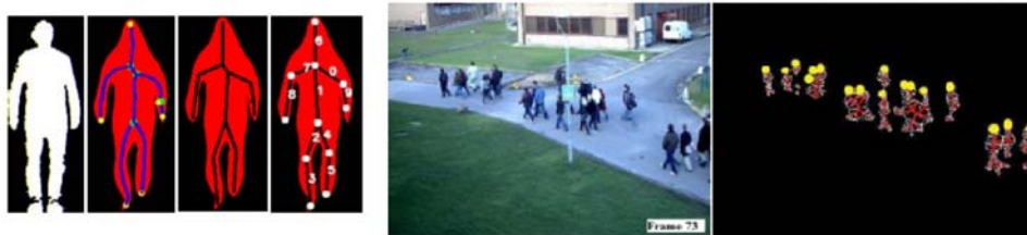
FIGURE 1.5: Exemple d'utilisation du squelette pour le représentation des piétons [Aziz 2011]. Le squelette des formes détectées est représenté sous la forme d'un graphe afin de détecter la position de la tête des piétons présents dans la scène et de mettre en place un processus de comptage de piétons.
