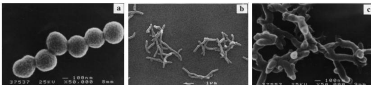
Figure 1-27. Particules de polyaniline stabilisée par l'hydroxypropylcellulose, 229 a) à 0°C, b) à 0°C en présence de phenylènediamine 2.3 \cdot 10^{-4} M, c) à 40°C.
