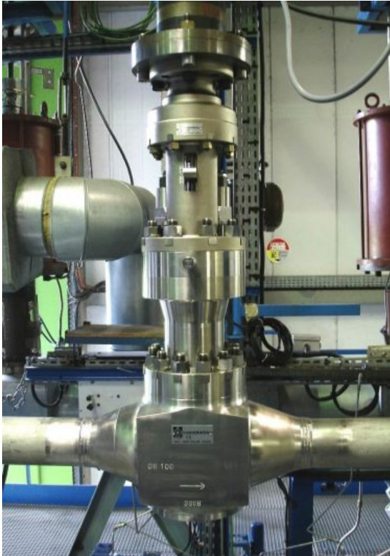
FIGURE 2: Robinet sur boucle d'essai (à gauche) et plan d'ensemble (à droite)
