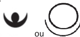
Figure 2.5 - Primitive de localisation d'un opérateur en VSM -
