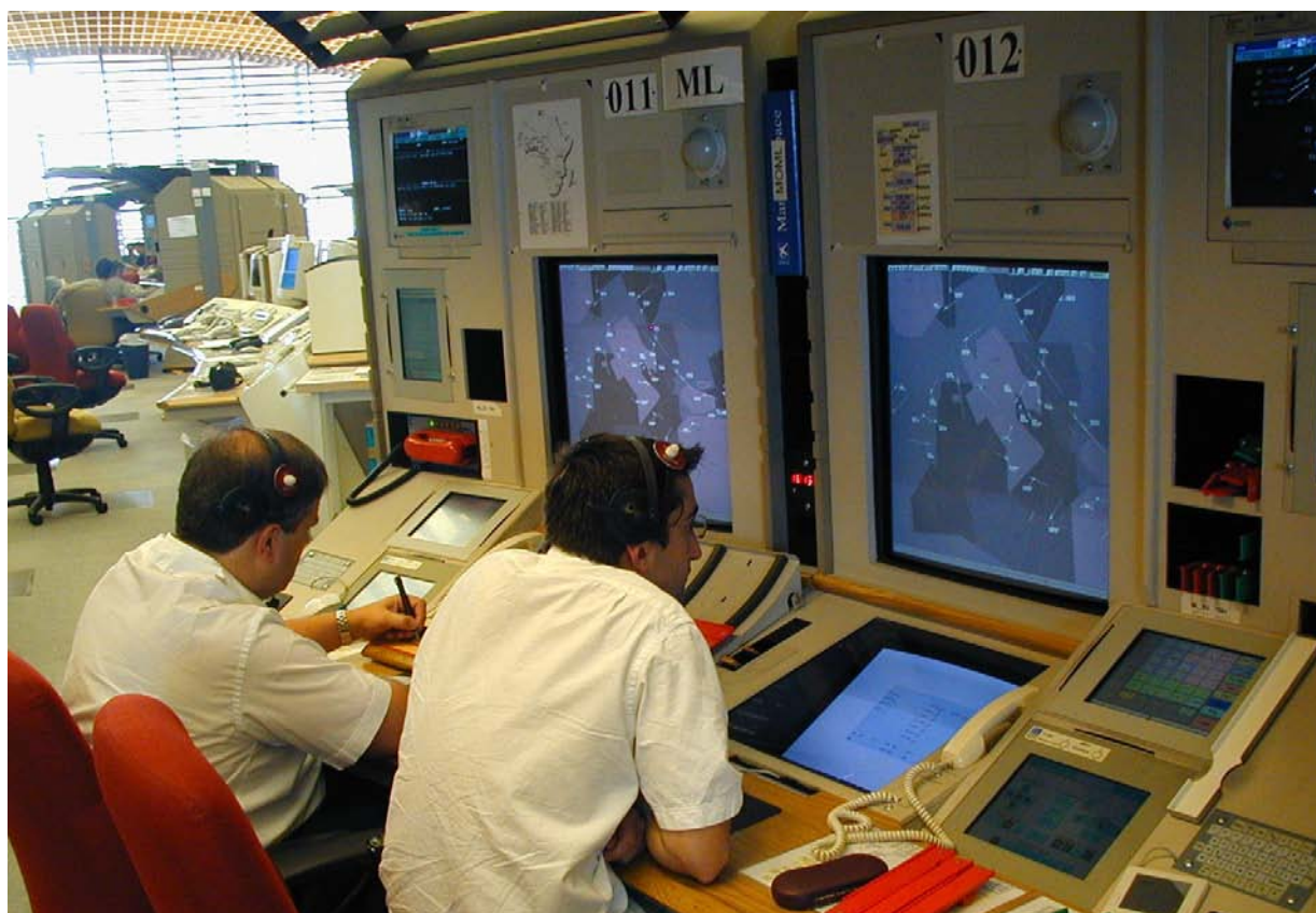
FIGURE 1.6 – Poste de contrôle dans le centre en-route d'Athis-Mons. Le contrôleur organique est à droite, le contrôleur tactique à gauche.
