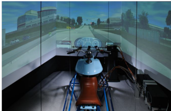
FIGURE 3.9 – Simulateur DIGEM. Extrait de Cossalter et al. [2010]
