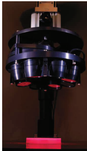
FIGURE 3.3 – Système d'Imagerie de Fluorescence en Réflexion appliqué à l'imagerie du petit animal développé par notre laboratoire.
