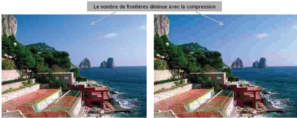
Figure 2.20 – Illustration des larges zones homogènes perçues pour des taux de compression élevés. [FR07]
