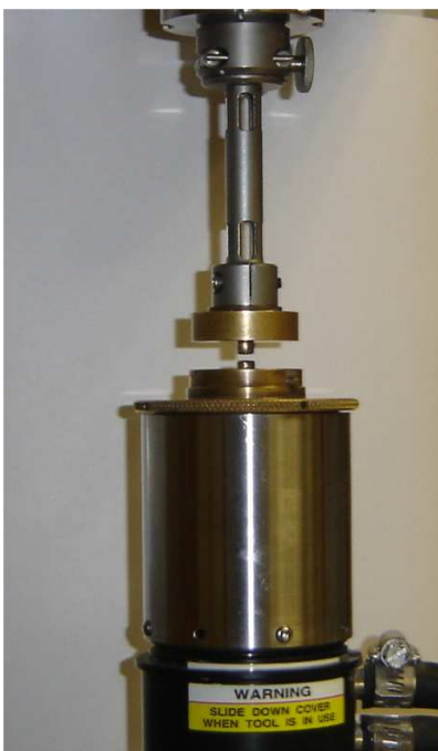
Figure 97 : Photographie de l'outil plan-plan utilisé pour les mesures de module élastique des pâtes au jeune âge.
