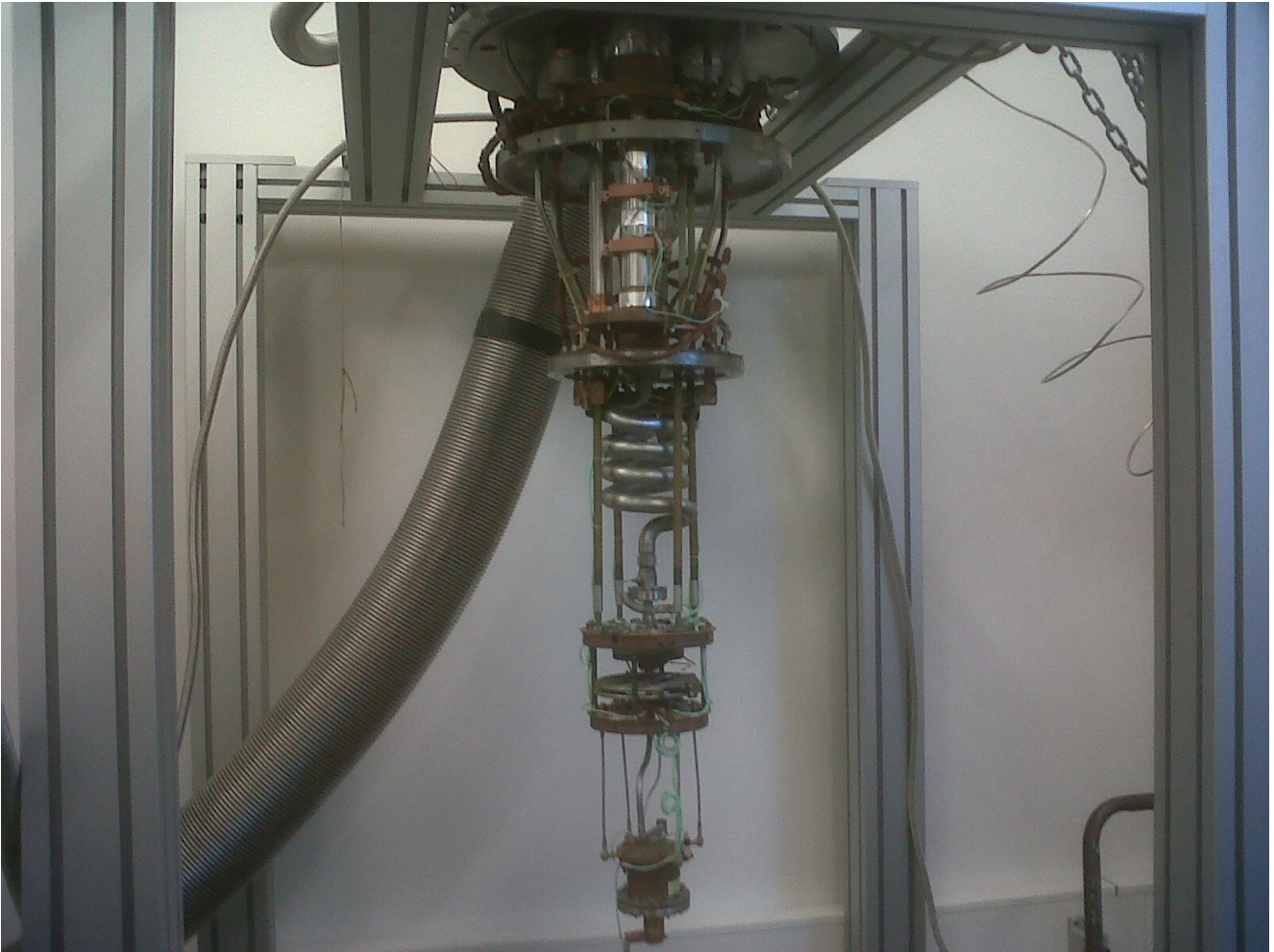
FIGURE 3.6 – Photo du réfrigérateur PTDR1 après modification du circuit d'injection.
