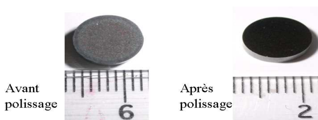
Figure II. 4 : Pastille d'UO 2 avant et après polissage
