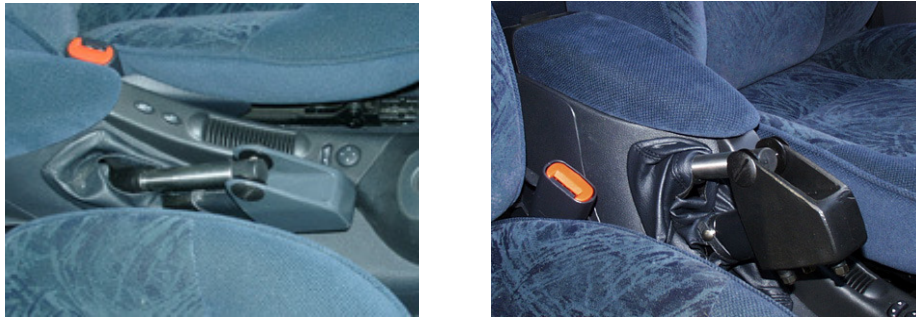
Fig I-12 Adaptation du frein à main : Dispositif électrique.
