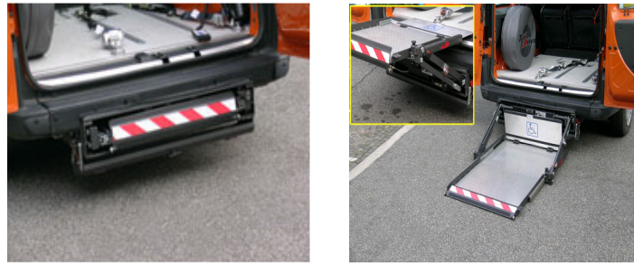
Fig I-40 Elévateur en arrière avec plate-forme télescopique.
