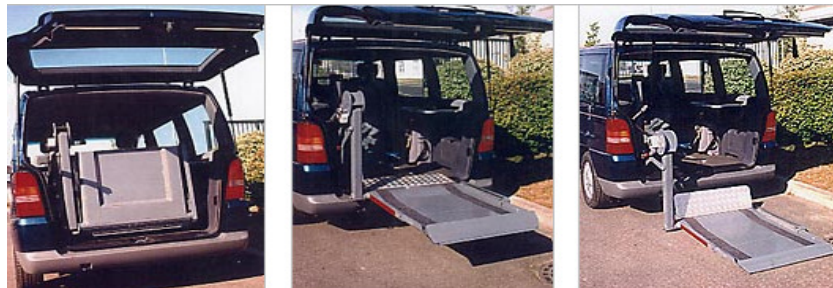
Fig I-38 Elévateur avec accès par porte arrière.
