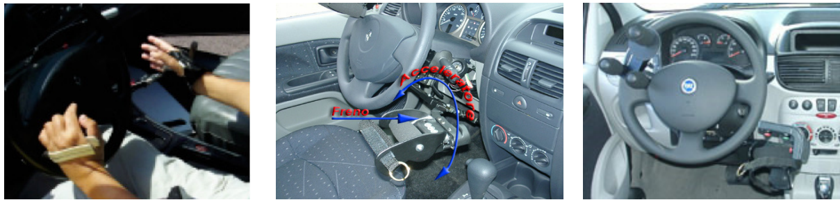
Fig I-34 Exemples d'aménagement pour tétraplégiques.
