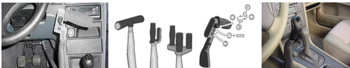
Fig I-33 Combiné Accélérateur-Frein à commande électrique.
