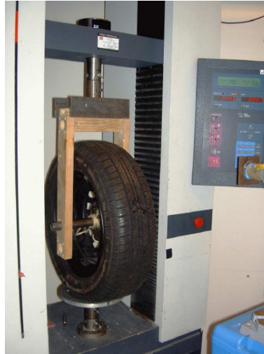
Fig III-39 Exemple d'expérimentation sur le contact pneu-chaussée.
