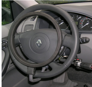
Fig I-17 Accélérateur par cercle mécanique.
