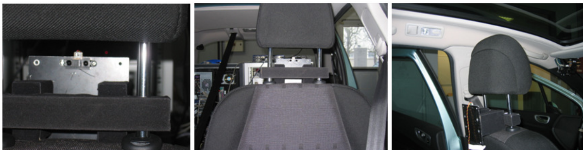
Fig II-18 Fixation du capteur de distance IR sur le siège conducteur du véhicule.
