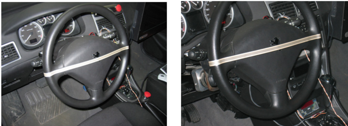
Fig II-16 Capteur de force placé sur le volant du véhicule.
