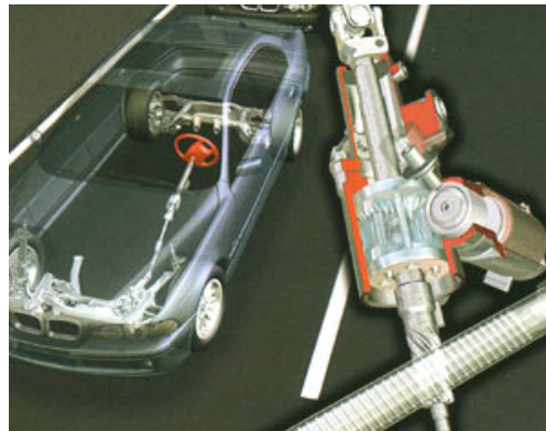
Fig III-6 Direction active développée par BMW.
