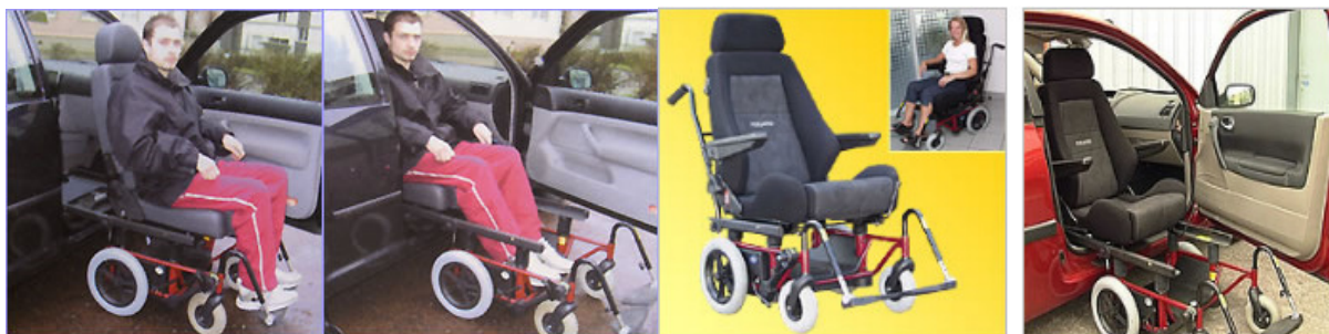
Fig I-51 Siège pivotant combiné à une embase roulante.
