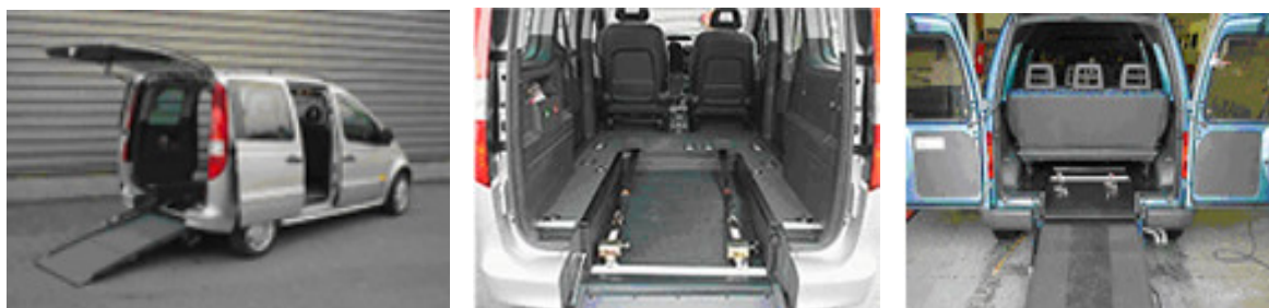
Fig I-44 Rampe avec abaissement du plancher.
