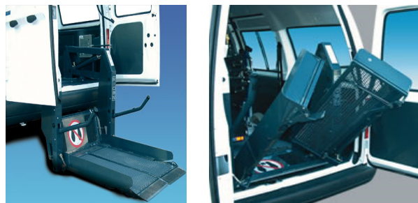
Fig I-39 Elévateur avec plate-forme pliable.
