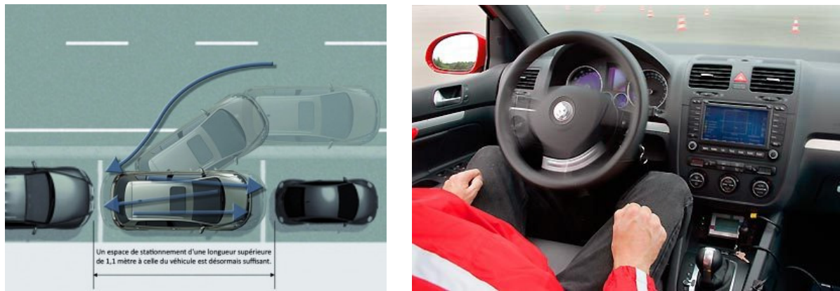
Fig III-7 Le dispositif d'aide au stationnement « Park Assist » de Volkswagen.
