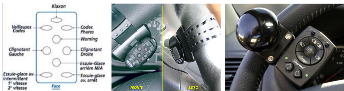
Fig I-3 Télécommande à infrarouge sur volant.
