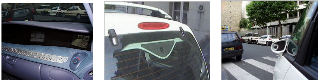
Fig I-16 Dispositif de caméras sur les rétroviseurs et la lunette arrière.
