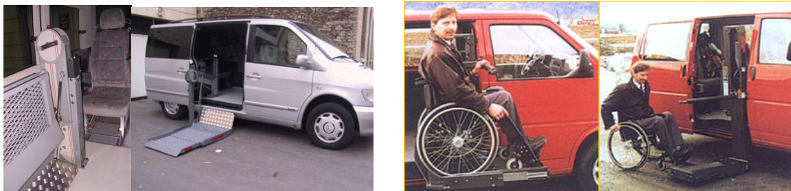
Fig I-41 Elévateurs avec accès par porte latérale.
