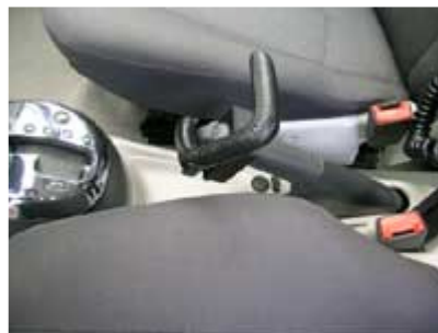
Fig I-11 Adaptation du frein à main : dispositif mécanique.
