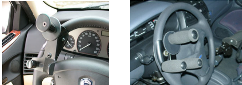
Fig I-7 Exemples de fourches à trois branches.
