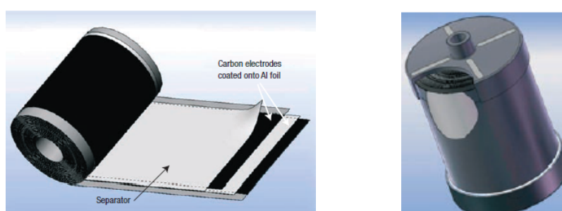
Figure 3. Vue éclatée (gauche) et bobinée (droite) d'un supercondensateur. 6
