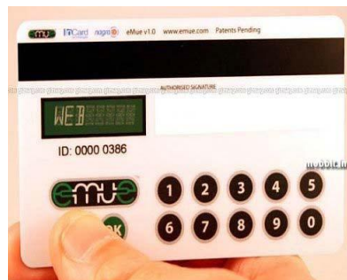
Figure 90: Exemple de carte à mot de passe unique utilisant une micro-batterie
