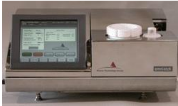
Figure 16: Omnietch : équipement de retrait couche par couche automatique
