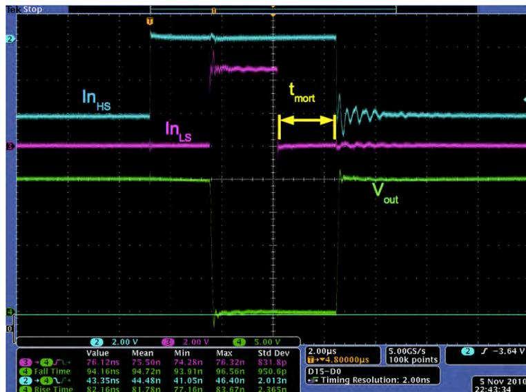
FIGURE 3.13 – Relevé des tensions de commande et de sortie
