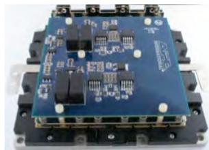
FIGURE 1.40 – Module APEI avec un étage driver plus compact
