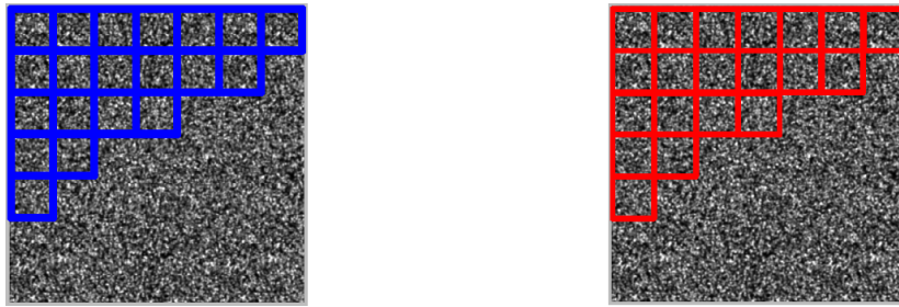
Fig 5.3 – Fenêtres d'interrogation. A gauche, image à l'instant t , à droite à l'instant t + \Delta t .
