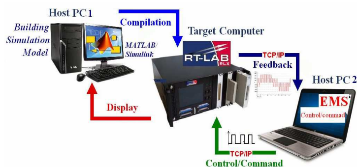
Figure III-17: Schéma conceptuel de la plate-forme HIL
