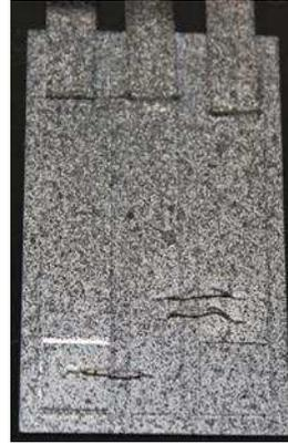
(b) Mouchetis appliqué sur l'éprouvette avec diode.
