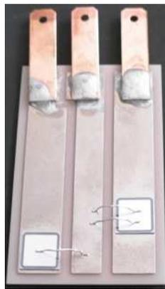
(a) Platine avec la diode contenant un et deux fils.
