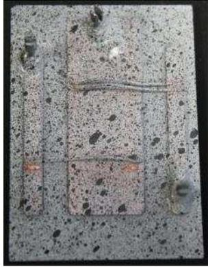
(a) Mouchetis appliqué sur l'éprouvette sans diode.
