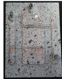
(c) Platine sans puce avec un et deux fils en parallèles, préparée pour une mesure de déplacement.
