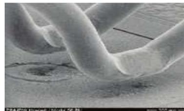
(b) Soulèvement des fils durant un cyclage thermique. [8]
