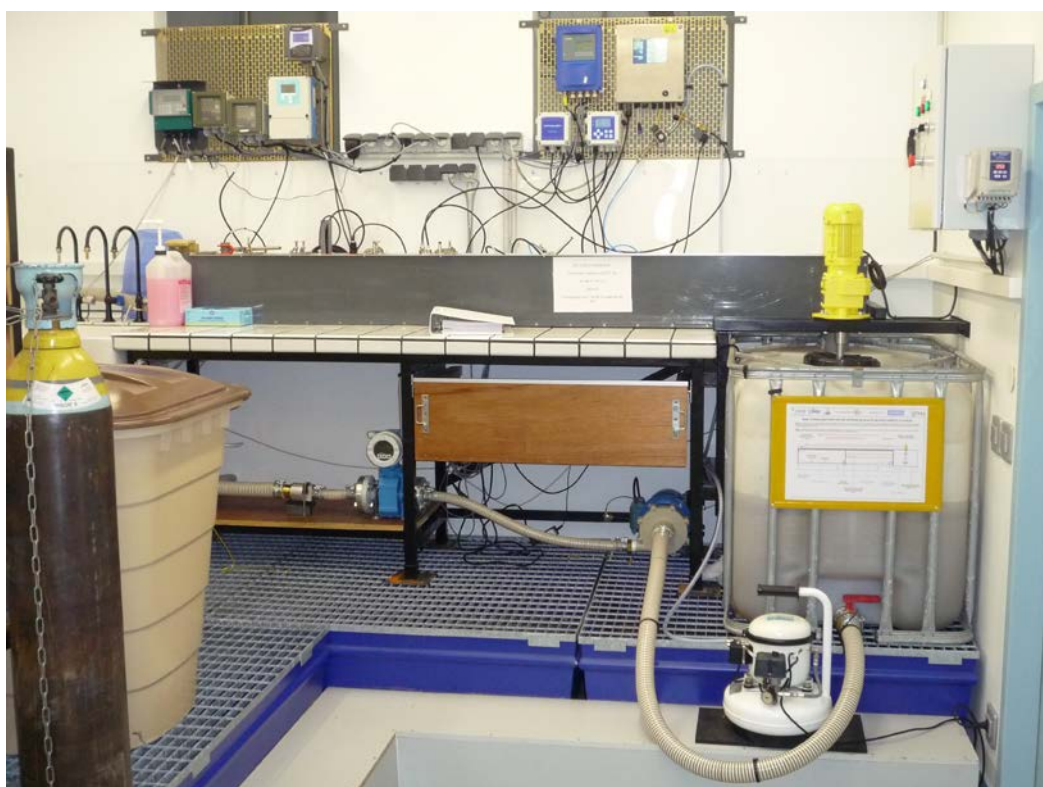
Photo II-5 : Vue générale du banc expérimental (M. Lepot)
