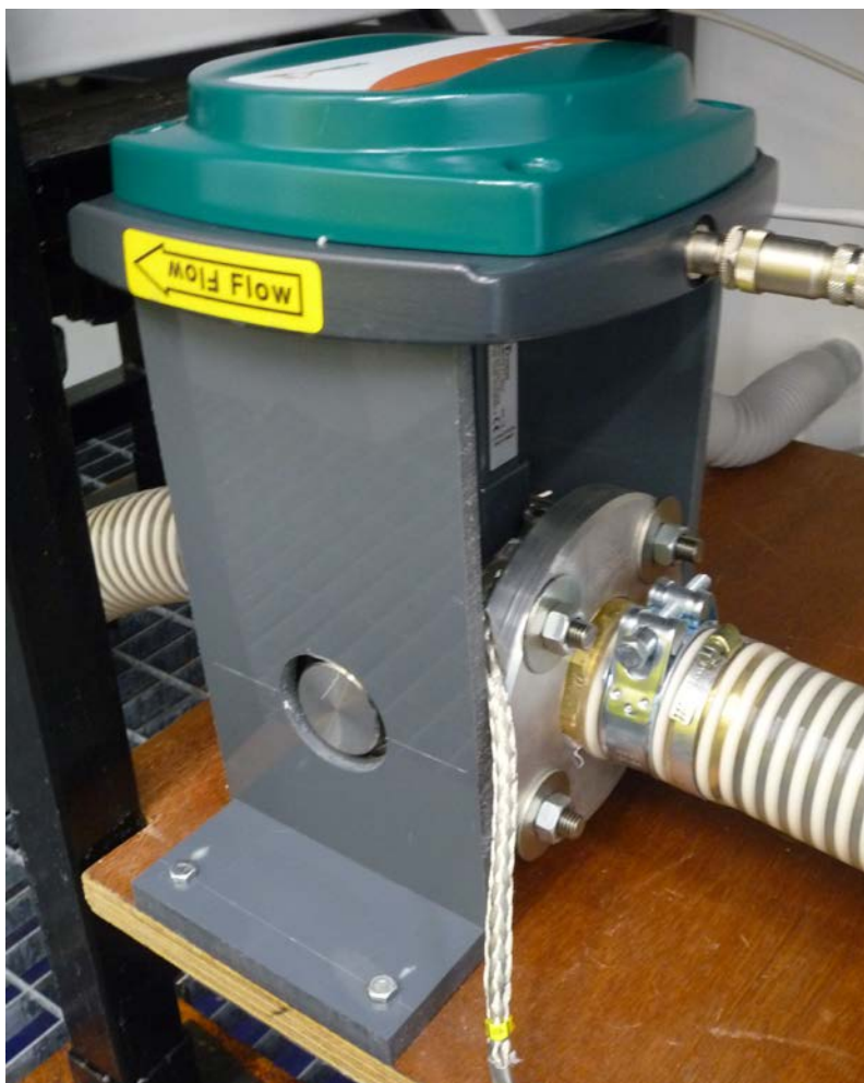
Photo II-9 : Sonde Kajaani TS installée sur le banc expérimental (M. Lepot)
