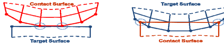
FIGURE 1.30 – Type de contact ANSYS WB et contrôle de la pénétration
