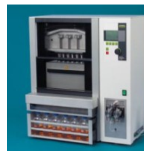
Figure 6 : Appareil d'extraction sous pression, Büchi Speed Extractor E-914
