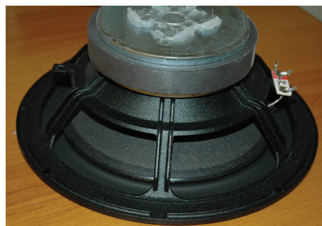
FIGURE 1.6 – Haut-parleur CA21 REX, membrane en cellulose
