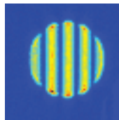
FIGURE 3.1 – Goutte d'eau ( 60 \mu\text{m} ), image obtenue par ILIDS
