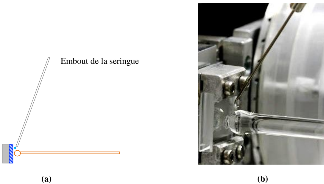
Figure 3.12 : (a) Vue de face de la mise en place d'une goutte de solvant entre la sphère et l'échantillon. Les dimensions sont à l'échelle 1/1. La sphère (en orange) a un rayon de 3 mm, l'échantillon (en bleu) a un diamètre de 1 cm et l'embout de la seringue est long de 5 cm et délivre des gouttes de 0.8 mm de diamètre. (b) : Photographie montrant une goutte au bout de l'aiguille de la seringue qui va être déposée entre l'échantillon et la sphère.
