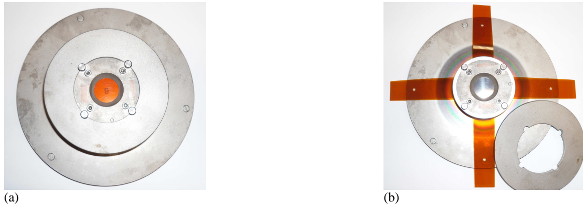
Figure II.2 : Porte-objet spécifique aux éprouvettes cruciformes (a) avant et (b) après dépôt.
