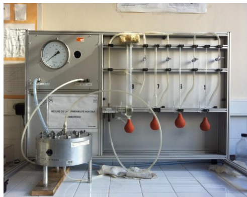
Figure II.17 : perméamètre à gaz Cembureau
