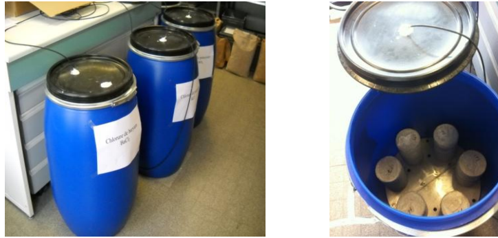
Figure III.3 : dispositifs de conservation sous 91\% < HR < 98\%
