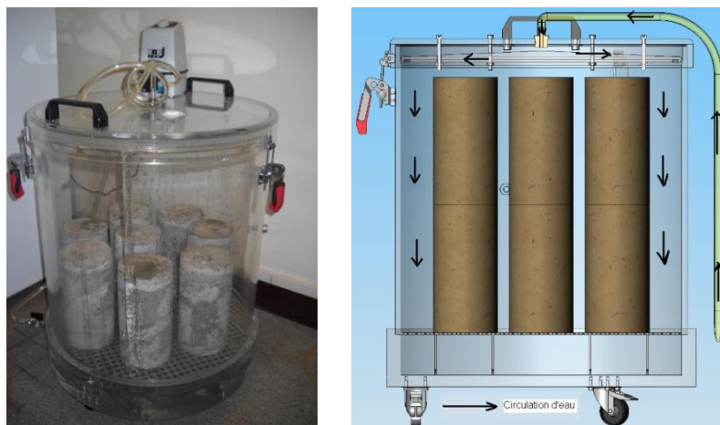
Figure III.2 : dispositif de maintien à 100% d'HR
