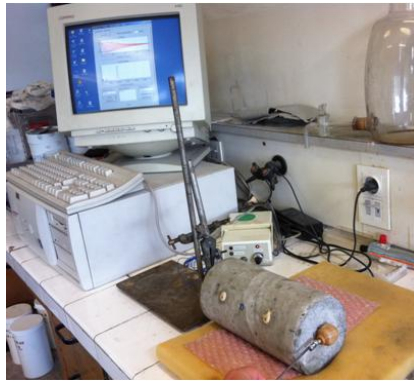
Figure II.13 : dispositif de mesure du module dynamique
