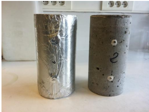
Figure II.10 : isolement du béton par des couches d'aluminium
