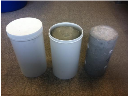
Figure II.9 : conservation des éprouvettes dans l'eau
