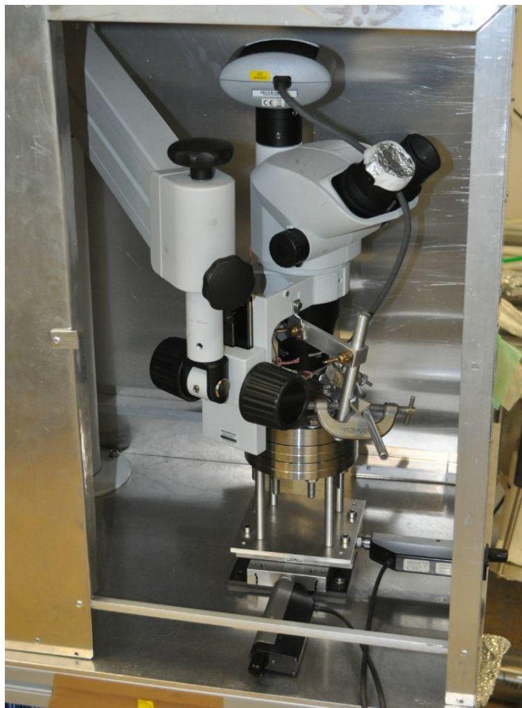
Figure III.4 - Dispositif de chauffe dans son enceinte : loupe binoculaire, caméra de contrôle, laser, enceinte ultra-vide et platine motorisée.
