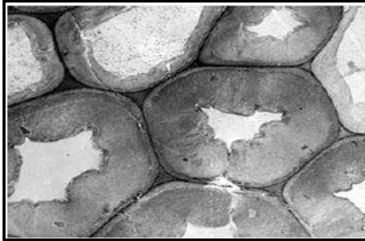
Figure 1.5 : Faisceau de fibres dans une tige de lin, coupe transversale
