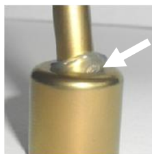
Figure 3.8 : Fuite et découpe partielle de l'anneau en silicone.
