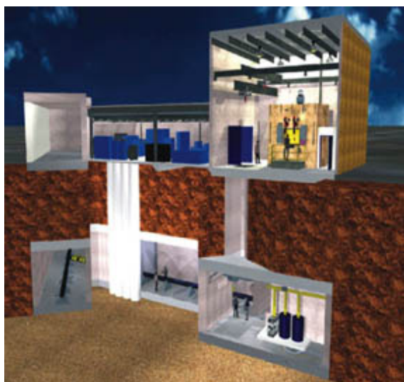
FIGURE 2.13 – Représentation de L'IPF (Isotope Production Facility) du LANSCE. En bas, le faisceau de proton arrive dans la chambre où se localise la cible d'hafnium. Après irradiation cette cible est récupérée par des moyens mécaniques pour être transportée dans une cellule chaude. Les opérateurs ayant travaillés sur cette cible ont utilisé des bras télémanipulés.
