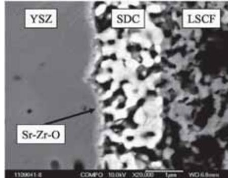
**Figure II-5 : Micrographie de l'interface LSCF/YSZ montrant la formation d'une couche composée de Sr, Zr et O malgré la présence d'une couche barrière SDC de 2µm [Simner2006]**
