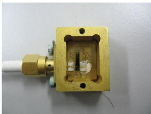
**Figure 4.4** – Photographie de l’échantillon fixé sur son support et relié aux instruments de mesures via un câble coaxial.
