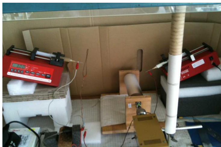
Figure 3-17: Photo du montage « electrospinning-electrospaying ».
