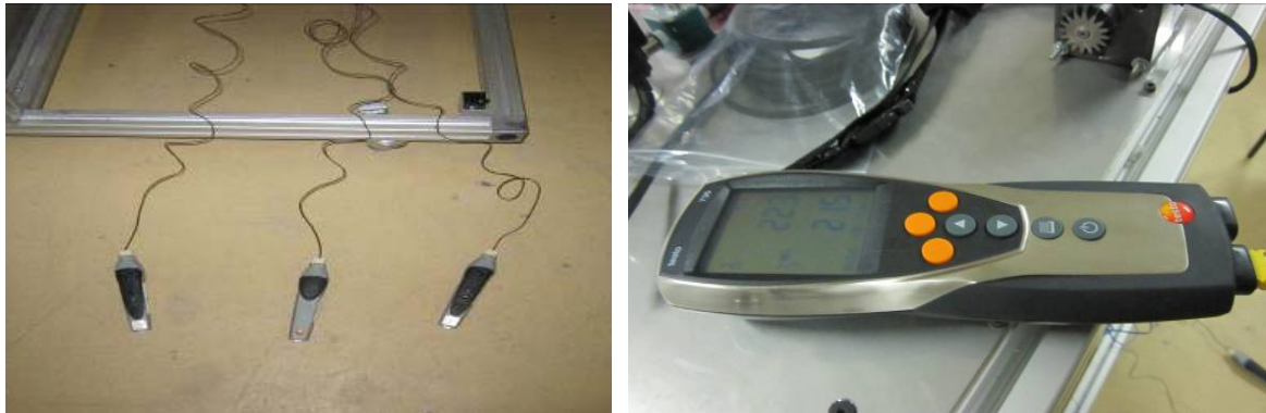
Figure II.2 : Les sondes et la visualisation Testo
