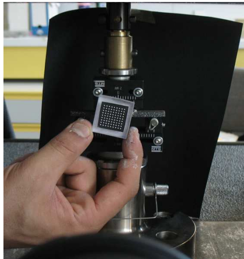
Figure 53. Mire d'étalonnage (9x9, 2mm) ayant des dimensions équivalentes à la zone d'intérêt
