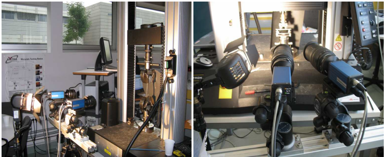
Figure 48. Banc d'essai de stéréo-corrélation constitué de deux caméras liées rigidement a) en traction, b) en flexion 4-points
