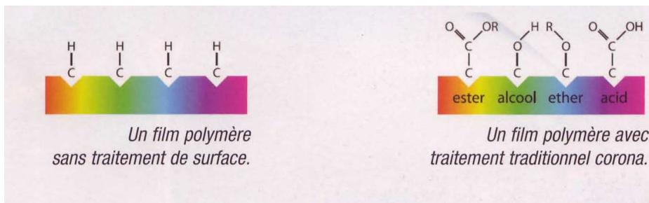
Figure 10. Effet Corona (activation de la surface d'un polymère par oxydation)
