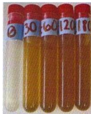
Figure 27. Coloration de milieu MGO relation 1:1 (grains d'orge: H 2 O) en fonction du temps d'infusion (minutes).
