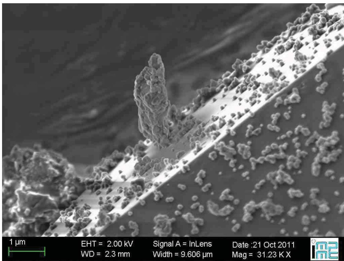
Figure IV.10 – Microsphères de silice présentes à la surface de la glushinskite, probablement formées par effet de « trempe ».
