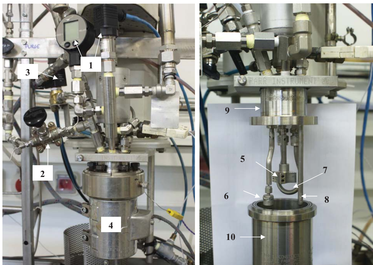
Figure II.2 – Vue détaillée du réacteur autoclave : éléments externes (à gauche) et internes (à droite). (1) : capteurs de pression, (2) : vanne de prélèvement d'échantillon, (3) : électrovanne du circuit de refroidissement, (4) : four annulaire, (5) : turbine d'agitation à dispersion de gaz (autoaspirante), (6) : tube plongeant équipé d'un fritté (2 \mu\text{m} ), (7) : serpentín de refroidissement, (8) : sonde de température dans un doigt de gant, (9) tête fixe du réacteur, (10) réacteur amovible en Hastelloy.
